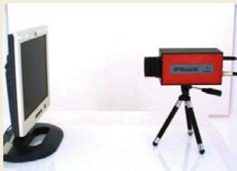
La fluidité d'affichage est évaluée en plaçant la sonde optique de l'Optiscope en face de chaque écran.
